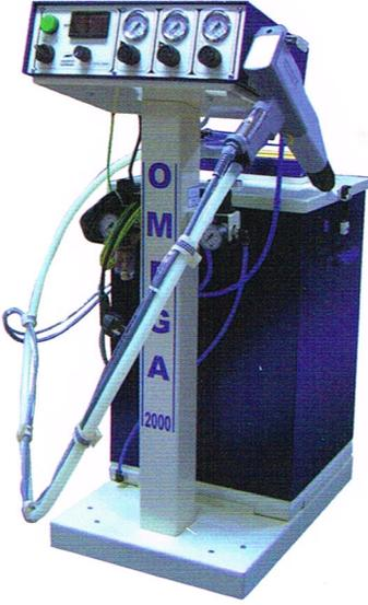
OMEGA 2000 cihazları yüksek teknolojiyle üretilmekte olup, verimli elektrostatik yükleme tekniği ve türbülanslı boya püskürtme teknolojisi sayesinde daha az boyayla daha fazla m<sup>2</sup> yüzey boyanmasını sağlamaktadır.
